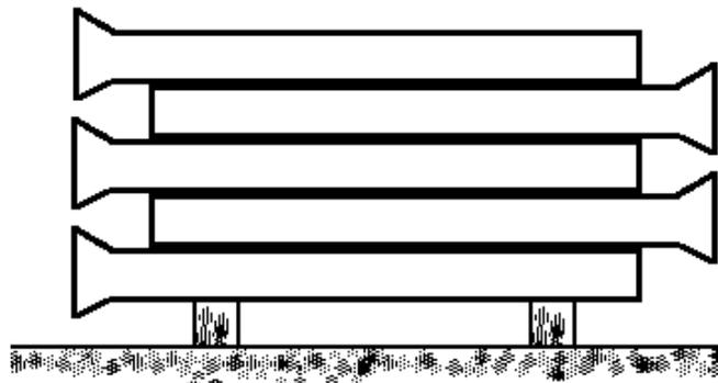
Con l'uno o l'altro sistema verranno limitate le altezze delle pile e, quindi, il numero degli strati in funzione inversa del diametro dei tubi, allo scopo di non sovraccaricare i tubi degli strati inferiori.
